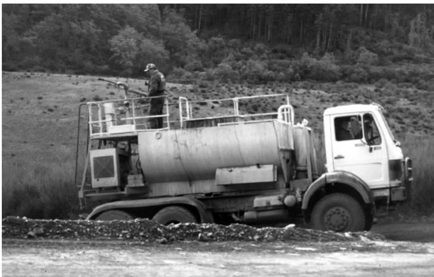
**Figura 12.** Hidrosembradora en las minas a cielo abierto de Barruelo de Santullán (Palencia)
