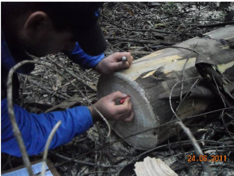
Figura 2. Medición de tensiones de crecimiento de *E. nitens* utilizando Sistema CSIR
