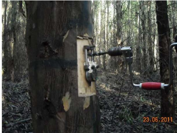
Figura 1. Medición de tensiones de crecimiento en *E. nitens* utilizando Extensómetro CIRAD
