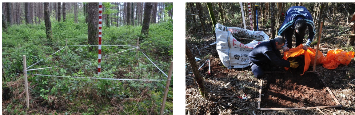
Figura 2. [Izquierda] Cuadrado para muestreo destructivo del combustible bajo dosel arbóreo. [Derecha] Mediciones, corte y recogida de combustibles en un cuadrado de muestreo
