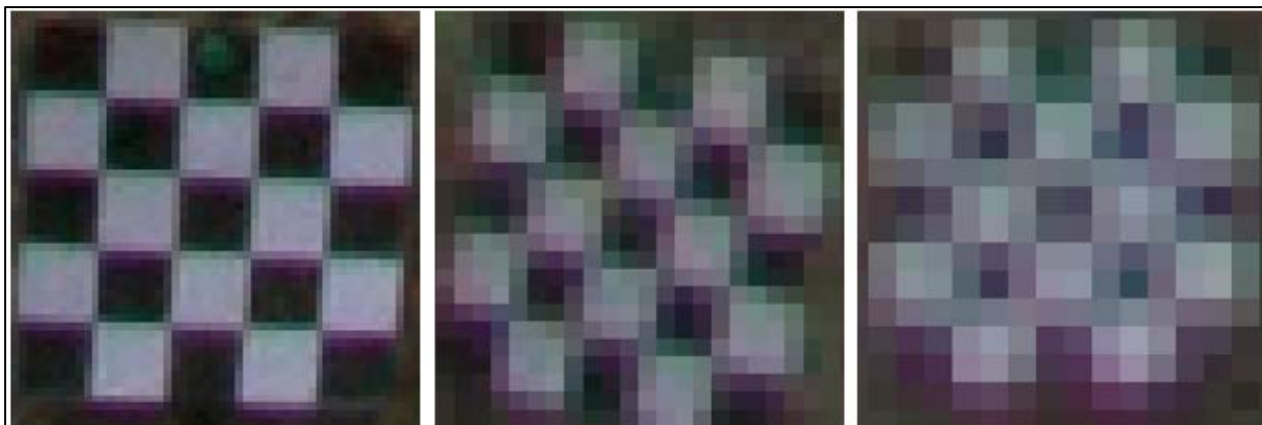
Figura 7. Pérdida de resolución de la imagen con la distancia. De izquierda a derecha patrón de 10*10 cm visto en la imagen panorámica 360° de alta resolución a 3,5 m (49 píxeles), 8 m (21 píxeles) y 12,7 m (13 píxeles).
