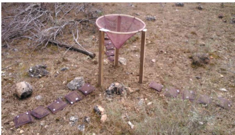
Figura 1. Dispositivo experimental establecido en cada parcela consistente en una trampa de desfronde y 15 bolsitas de descomposición
