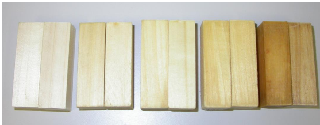
Imagen 4. Probetas de Populus x euramericana de izquierda a derecha; sin tratamiento, O 20°C, O 80°C, O 130°C y O 170°C en aceite reciclado de girasol durante 1 hora.
