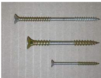
Figura 3. Extractor de tornillos Figura 4. Tornillos de 3, 4 y 5 mm
