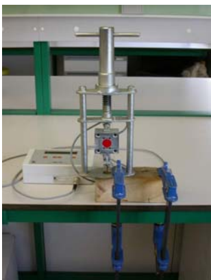
Figura 3. Extractor de tornillos Figura 4. Tornillos de 3, 4 y 5 mm
