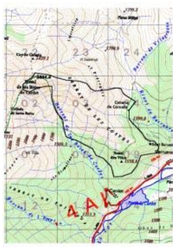
Figura 4: Ejemplos de formas de perímetros de incendio en función del factor de propagación (topográfico en ascenso por las laderas, de viento siguiendo la dirección del viento general y de combustible moviéndose según la disponibilidad del mismo).
