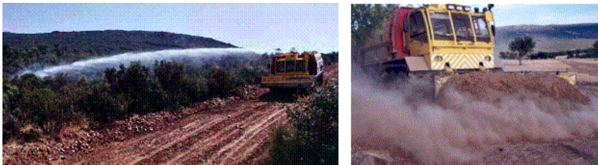
Figura 3. El cañón monitor puede impulsar agua o espuma, en forma de chorro o en aspersión, mientras la potente pala, tipo angledozer, le proporciona continuidad en la extinción de incendios.
