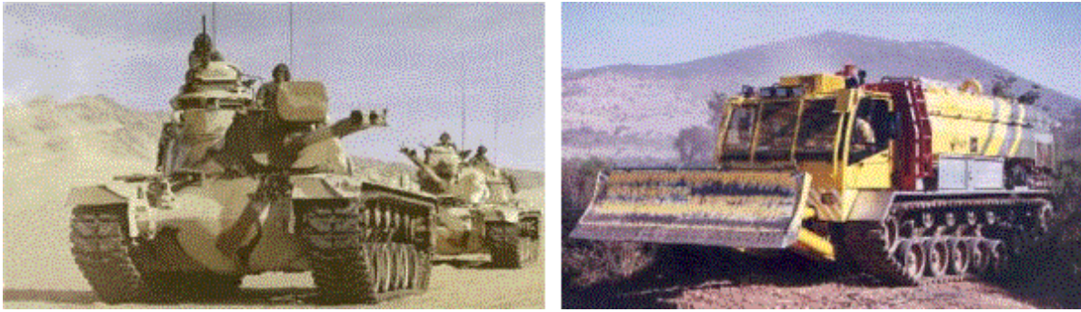
Figura 1. Con el proyecto V.E.L.I.F. se ha conseguido la modificación de un carro de combate M48 A5E2 en un medio altamente eficaz para la extinción de incendios forestales.
