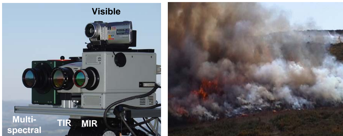
Figura 2.- (Izquierda) Las cámaras montadas sobre un trípode en los ensayos de campo. (Derecha) Un momento de la quema observado a 220 m de distancia, en la banda visible
