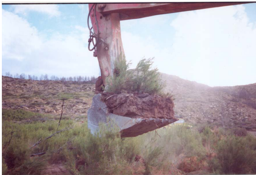
Figura 1. Transporte en el cazo de la retroexcavadora del cepellón con los brinzales
