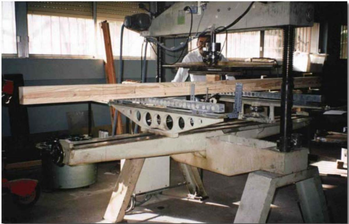
Foto1: Realización del ensayo de Resistencia a flexión, en el Laboratorio de Control de Calidad de Sevilla.
