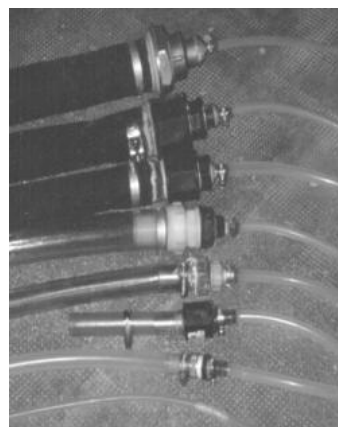
Foto 2. Tubos de caucho y de PVC utilizados para inyectar gas en las ramas. El extremo de la izquierda se conecta con el extremo proximal de la rama, y el de la derecha se conecta a una bombona.
