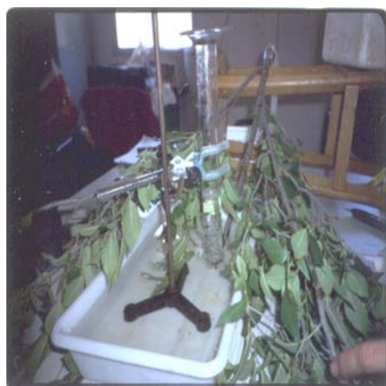
Foto 1. Detalle de una medición del gas saliente por el extremo distal en una rama de 4 años de un ejemplar de U. minor x U. pumila (MPZ 3). El gas se recoge en una probeta invertida llena de agua, y el tiempo es cronometrado
