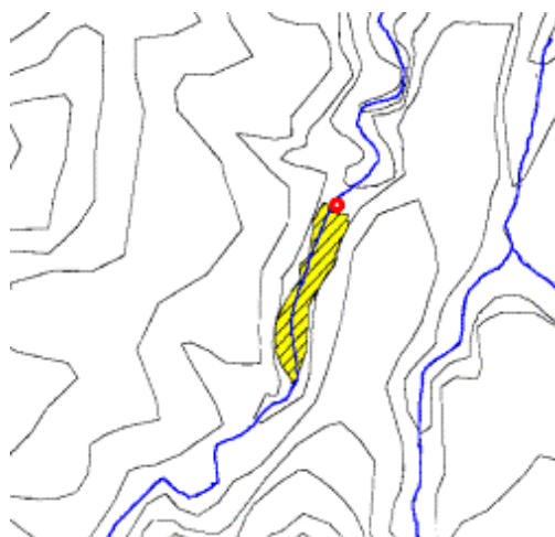
Figura 2. Cuña de sedimentos de uno de los diques en Rambla de Cárcavo.
