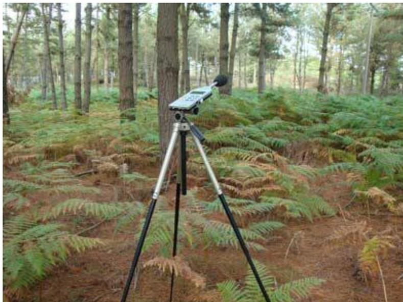
*Figura 4 : Toma de datos con el sonómetro en un punto de muestreo*
