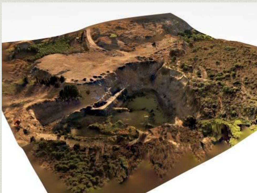
*Figura 18. Modelo Digital de Superficie con textura de ortofoto de alta resolución, generado para la cubicación del vertido*
