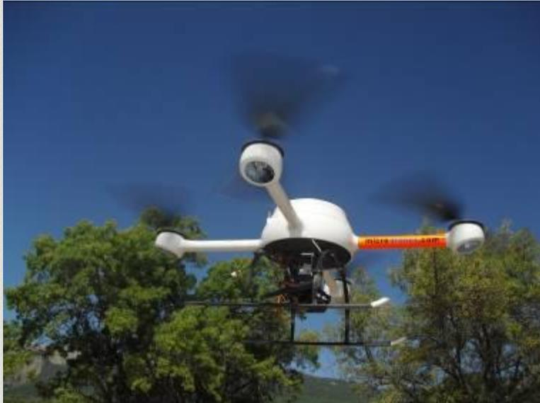
Figura 1. UAV de ala rotatoria (Microdrone MD-200)
