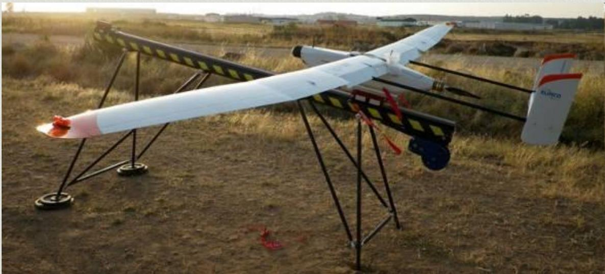
Figura 2. UAV de ala fija (Elimco E300)
