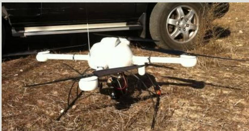
Figura 8. UAV con sensor térmico integrado
