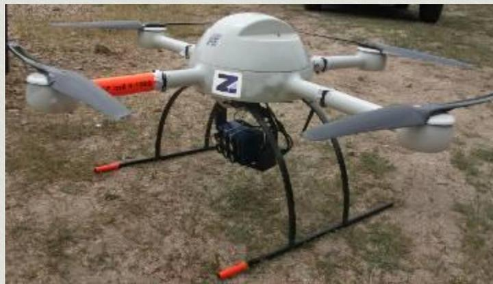
*Figura 6. Vehículo Aéreo No Tripulado equipado con sensor multiespectral de 6 bandas*
