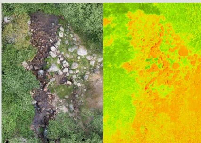
Figura 22. Comparación de resolución en el cálculo de NDVI entre imagen de satélite LANDSAT 7 e imagen UAV
