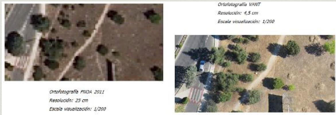
Figura 4. Comparación de resolución entre ortofotografía correspondiente al PNOA 2011 y la realizada mediante UAV.
